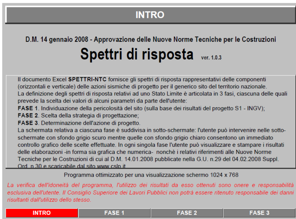
Figura 13: descrizione del programma utilizzato per la definizione degli spettri.
