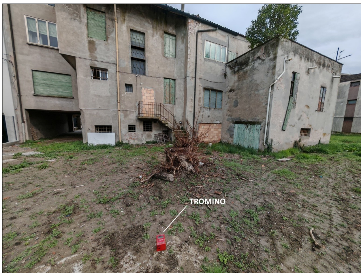
Figura 4: esecuzione della prova geofisica con adeguata strumentazione ( TROMINO ).
